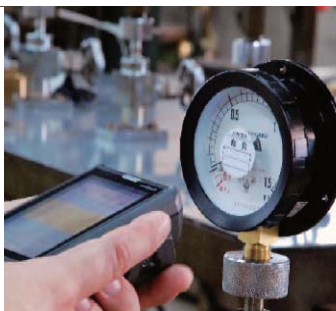
RFIDタグ圧力計による 設備保全管理システム
